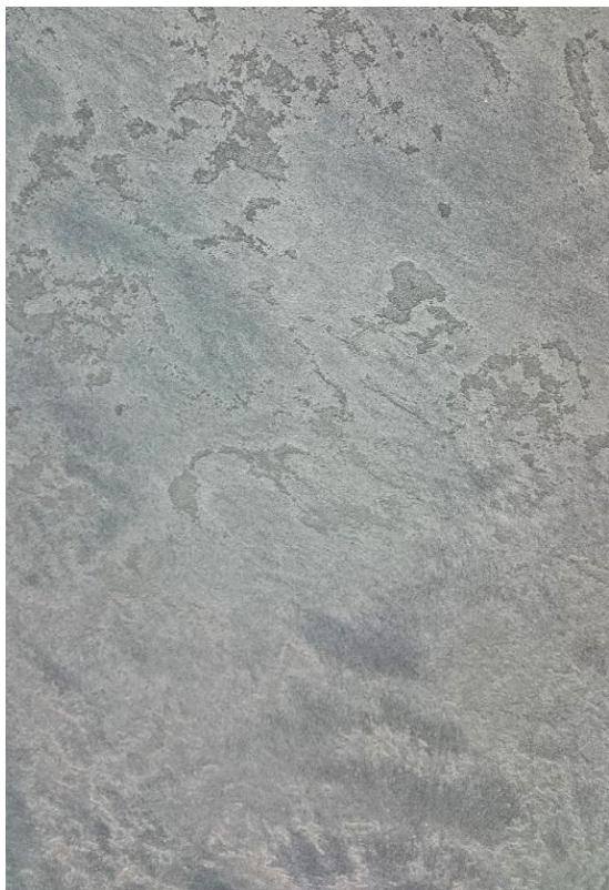
Матовое декоративное покрытие со сферическим микросферами, для получения "3D" светорассеивающего эффекта. Эффект отражающего светового перелива достигается за счет рассеивания света сферической поверхностью микросфер.
